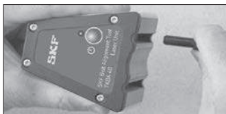
Figura 2 Como encaixar ou remover as guias em V
