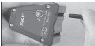
Рис 2 Установка и удаление V-направляющих
